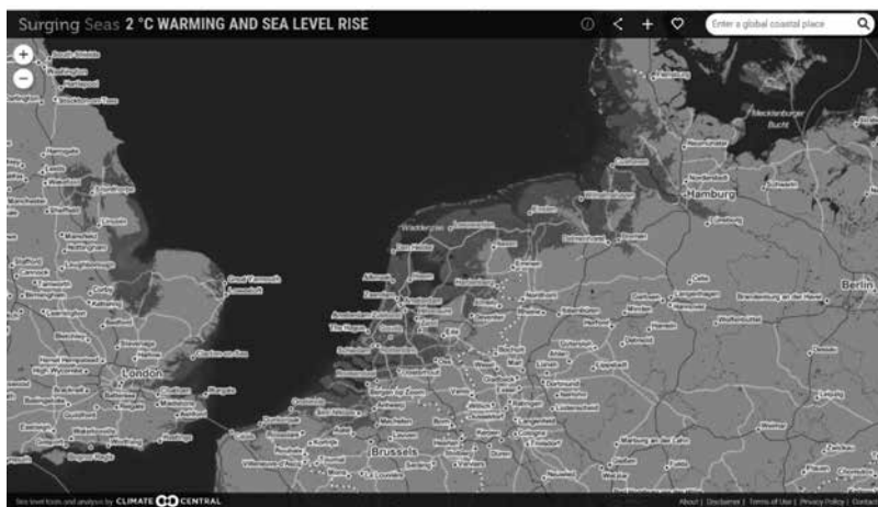
Figura 3 – Simulação da subida do nível do mar para um acréscimo de 2° C da temperatura global da Terra 19 . Note-se que a linha final da costa é recuada face à origina, sendo que essa realidade é particularmente sensível em zonas costeiras de gradiente suave e baixa altitude. Os espaços marítimos à luz da CNUDM teriam de ser revistos, mediante as novas linhas de base, o que contradiz o princípio estipulado no Artigo 62° (2)(a) da Convenção de Viena.
